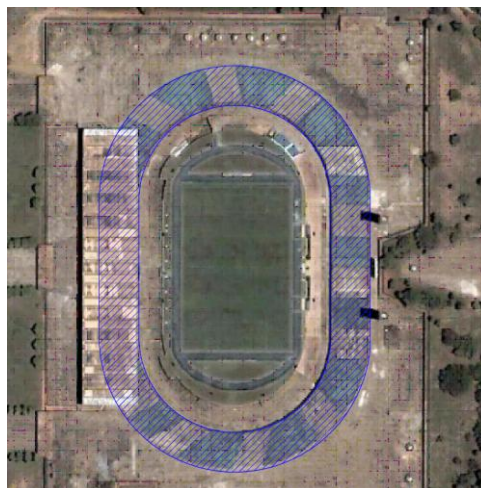
Figura 10 - Estádio Verdão, com área total para integração fotovoltaica hachurada em azul.
